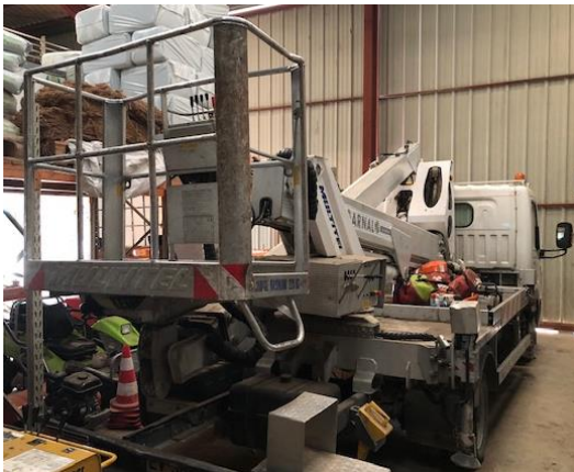
Camion Nacelle 20m
